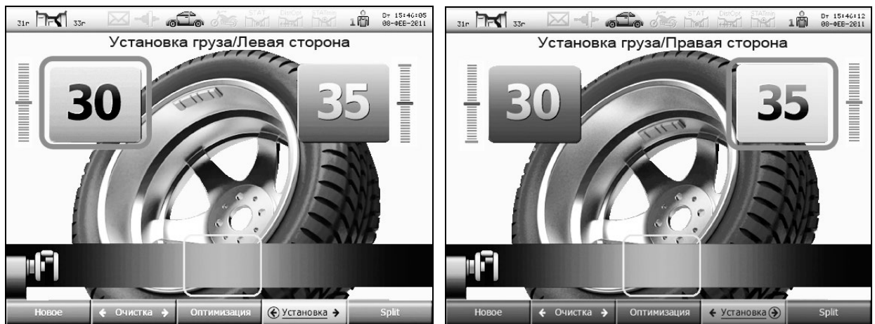
Рисунок 6.11 – Схемы установки грузов
