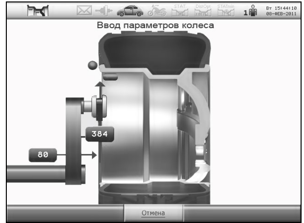
Рисунок 5.3 – Экран при первом измерении
