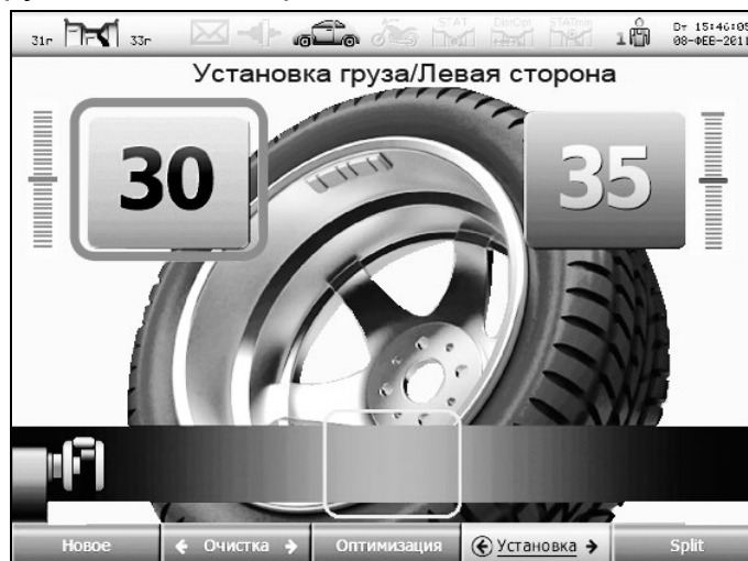
Рисунок 5.12 – Экран при установке груза линейкой
