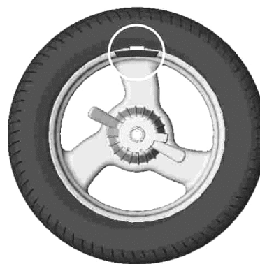
б - груз установлен в положение «12 часов»
