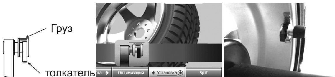
Рисунок 5.13 – Установка груза линейкой
