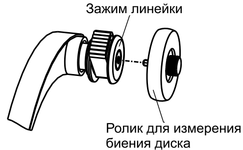
Рисунок 7.5 – Ролик для измерения биений
