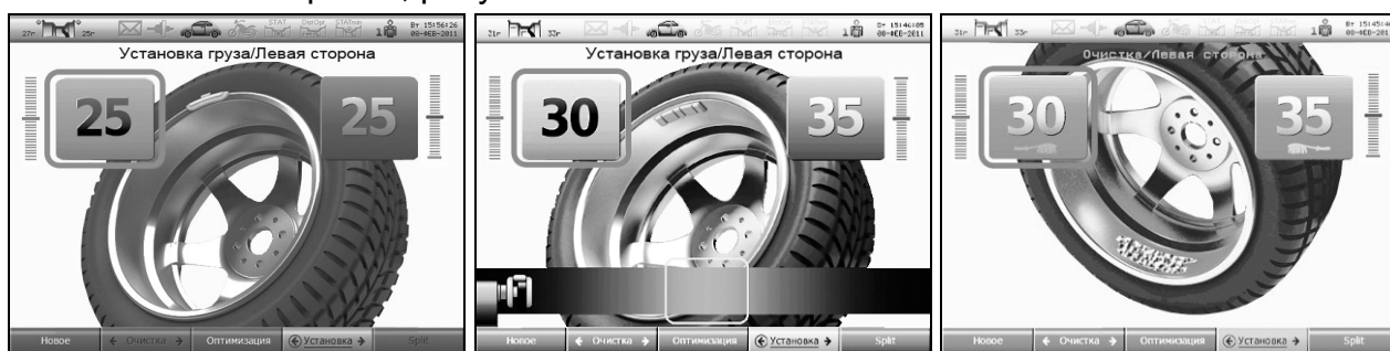
а – установка груза в «12 час» б – установка груза линейкой в – очистка
