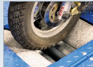
Роликовый агрегат оснащен пневматическим подъемником и тормозом
