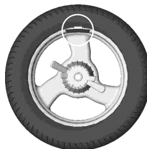
Рисунок 6.6 - Груз установлен в «12 часов»
