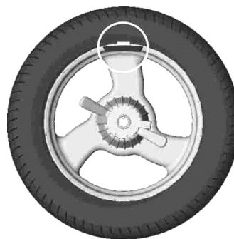
б - груз установлен в положение «12 часов»
