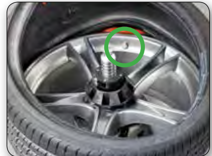
Демонтаж нижнего борта
