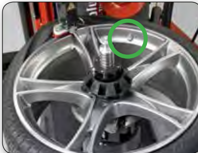
Демонтаж верхнего борта
