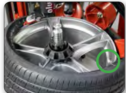
Монтаж верхнего борта
