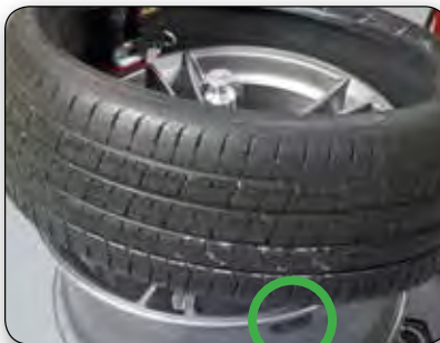
Монтаж нижнего борта
